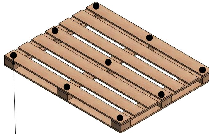
Puntos reforzados con tornillos de 5 pulgadas
