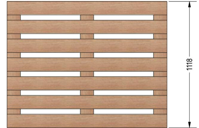
Las piezas se unen entre si con clavos espiralados de Ø3,4 mm
